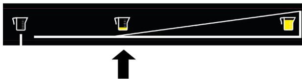
Le point exact de départ du flux dépend de la configuration du pulvérisateur. Déplacez la poignée lentement et progressivement tout en observant attentivement la sortie lorsque le flux démarre.
