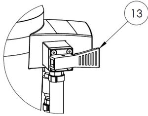
Après avoir nettoyé l'extérieur du bouchon Easyconnect et les pièces internes du Cleanload Nexus, relâchez le levier d'eau de rinçage (13).
