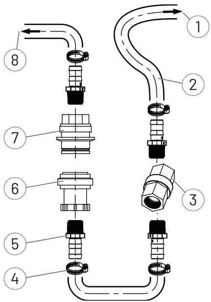
L'autre extrémité du flexible d'aspiration doit être raccordée à la conduite d'aspiration qui alimente le réservoir du pulvérisateur.
