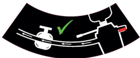
**AVERTISSEMENT** L'aspiration doit toujours être mise en marche et venir du Nexus Cleanload avant de fixer un bidon.
