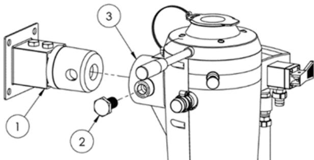
Veillez à fixer solidement le point de montage (1) au pulvérisateur, à l'établi, au mur ou à un support.
