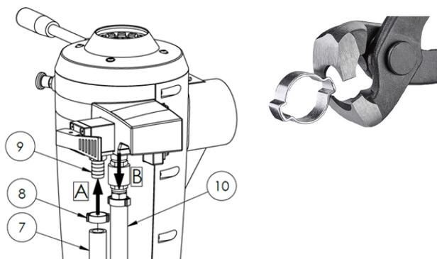
Le flexible d'alimentation en eau de rinçage (7) se raccorde à l'embout d'alimentation en eau de rinçage (9) en position A.
