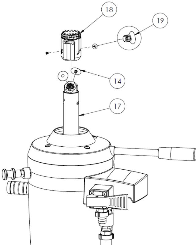
À l'aide d'un tournevis Torx T10, déposez les 2 vis (19) qui maintiennent la tête de cane (18) sur l'ensemble (17).
