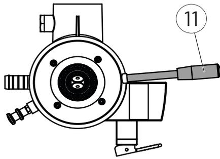
Cette opération peut être effectuée avec le Cleanload Nexus en place et avec le flexible d'aspiration et le flexible d'eau de rinçage raccordés au pulvérisateur.
