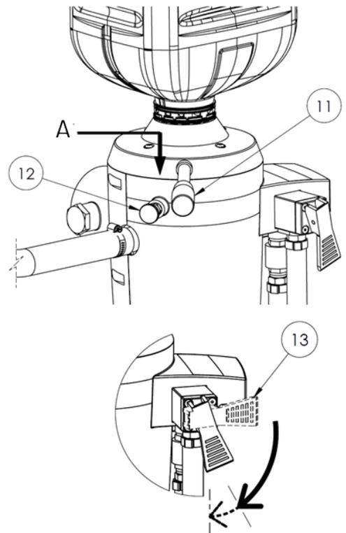
**Remarque** : Si la poignée de commande (11) N'EST PAS dans la position de rinçage correcte (A), le levier d'eau de rinçage (13) tourne partiellement mais ne s'engage pas et ne fait pas fonctionner le rinçage.
