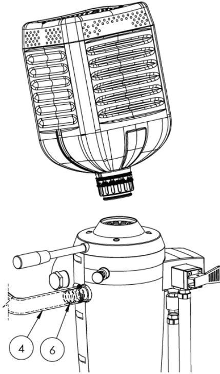
Retournez le bidon et placez-le sur le Cleanload Nexus, comme illustré. La bride du bouchon Easyconnect doit se mettre en place, tenez le bidon d'une main.
