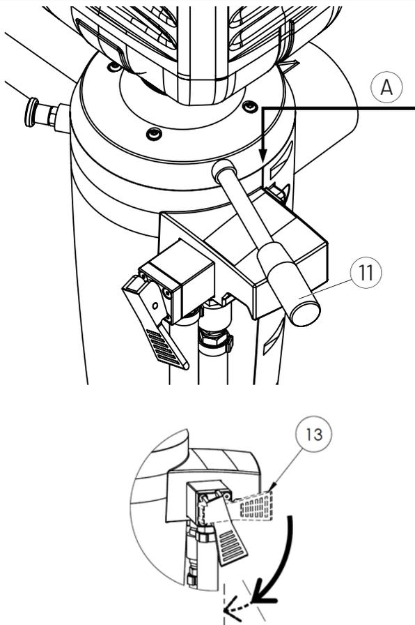
**REMARQUE** : La poignée de commande (11) doit être dans la position de rinçage correcte (complètement à droite en position A) ; si la poignée n'est pas correctement alignée, le levier d'eau de rinçage (13) tourne partiellement, mais il n'est pas possible de le soulever ni de procéder au rinçage.
