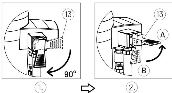
À ce stade, l'extérieur du bouchon Easyconnect doit être rincé. Avant de rincer, abaissez et relâchez le flexible afin que le liquide puisse s'écouler du connecteur.
