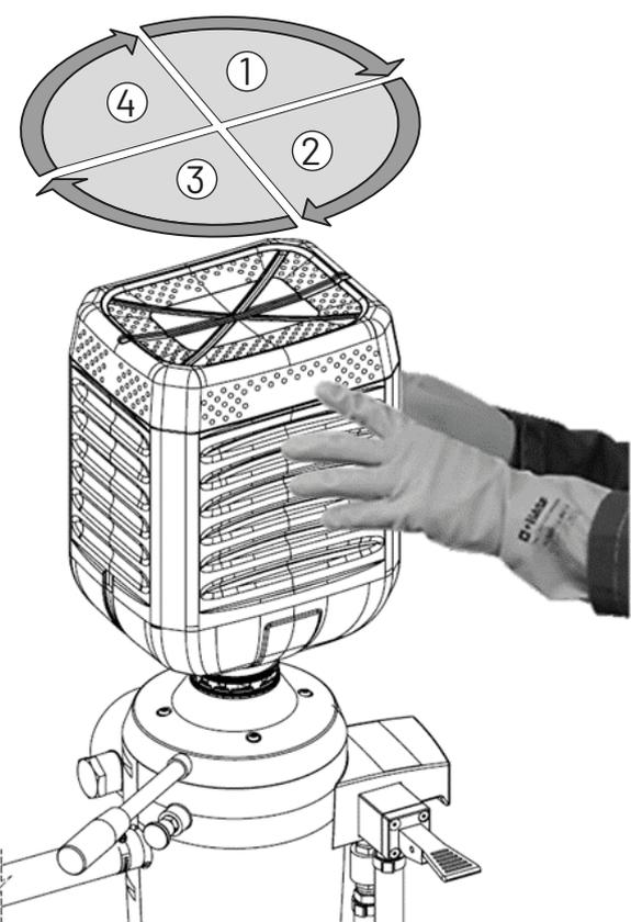
Activez le rinçage pendant 10 secondes, puis faites pivoter le bidon de 90 degrés vers la gauche (dans le sens horaire), puis relâchez le levier d'eau de rinçage. Répétez l'opération 3 fois pour un total de 40 secondes, afin d'assurer un rinçage optimal.
