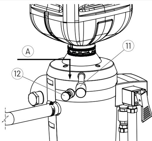
**REMARQUE** : Si la poignée de commande (11) N'EST PAS dans la position de rinçage correcte (A), le levier d'eau de rinçage (13) tourne partiellement mais ne s'engage pas et ne fait pas fonctionner le rinçage.
