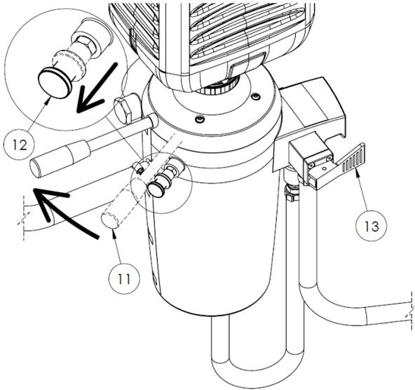
Le bidon peut être libéré en tirant sur le bouton de déverrouillage (12) tout en déplaçant la poignée de commande (11) vers la gauche.
