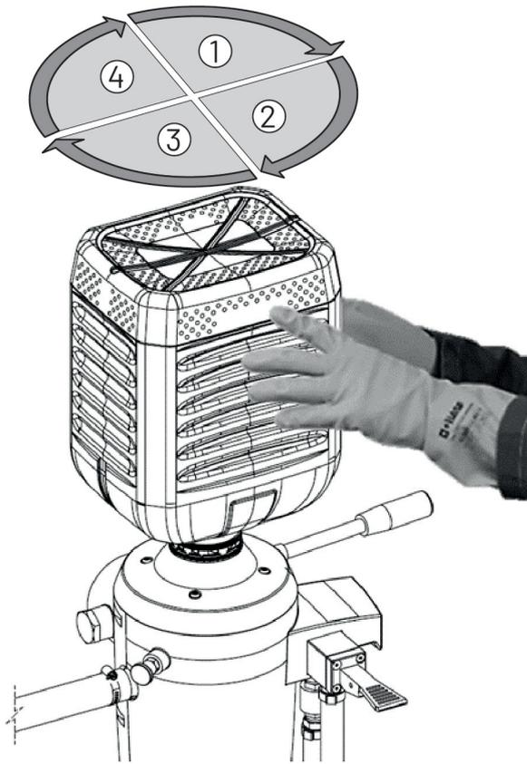
Activez le rinçage pendant 15-20 secondes, puis faites pivoter le bidon de 90 degrés vers la gauche (dans le sens horaire), puis relâchez le levier d'eau de rinçage. Répétez l'opération encore 3 fois pour un total de 60-80 secondes.
