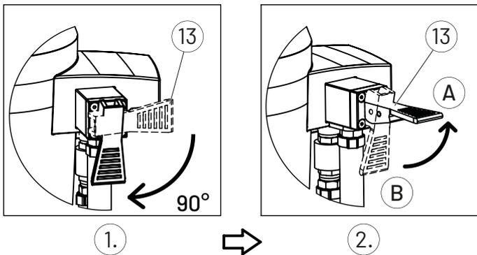
Pour activer le rinçage, tournez le levier d'eau de rinçage (13) de 90 degrés dans le sens horaire (étape 1) et soulevez-le pour libérer l'eau de rinçage (étape 2).
