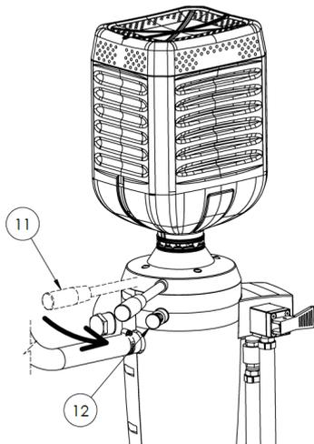
Pour fixer le bidon au Cleanload Nexus, déplacez la poignée de commande (11) vers la droite (dans le sens anti-horaire) jusqu'à ce qu'elle dépasse le symbole de cadenas fermé et s'arrête lorsqu'elle est alignée avec le bouton de déverrouillage (12) et l'image des gouttelettes comme illustré :
