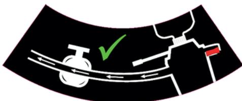
**⚠ Warnung** Die Absaugung muss immer eingeschaltet sein und von der Cleanload Nexus absaugen, bevor ein Behälter angebracht wird.
